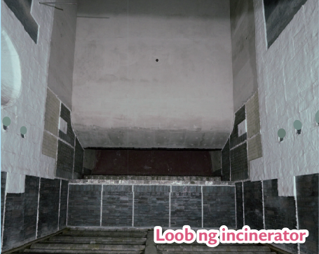
Incinerator Ang automatic combustion control sa incinerator ay sinisugurado ang ganap na pagkakasuog ng mga basura. Sa pamamagitan ng pagsunog sa isang mataas na temperatura na 850°C o higit pa, ang pagkakabuo ng mga nakakapinsalang kemikal tulad ng mga uri ng dioxin, atbp. ay napipigilang. Ang high-temperature air combustion technology ay nagbibigay-daan sa patuloy (walang palya) na pagsusunog gamit ang kaunting hangin.
