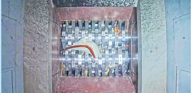
Low-speed rotary crushing machine Ang dalawang blade na umiikot na magkaharap ay ginagamit upang pagpira-pirasuhin ang mga kasangkapang gawa sa kahoy atbp.
