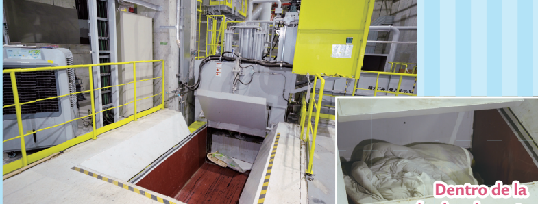
Máquina de corte vertical Los residuos combustibles blandos y de gran tamaño, como los tatamis y los futones, se cortan en longitudes fijas con potentes cuchillas.
