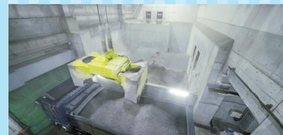
**灰渣貯坑和飛灰處理物坑**
