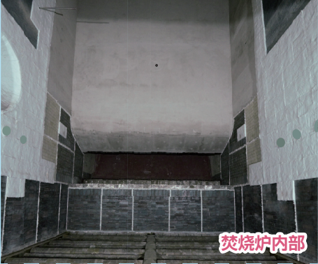
焚烧炉 焚烧炉通过自动燃烧控制使垃圾完全燃烧。通过850℃以上的高温燃烧，抑制二恶英类等有害物质的产生。采用高温空气燃烧技术，只需少量空气即可进行稳定燃烧。
