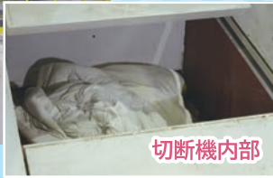
縦型切断機 畳や布団などの柔らかい燃やせる粗大ごみを、強力な刃物で一定の長さ切断します。
