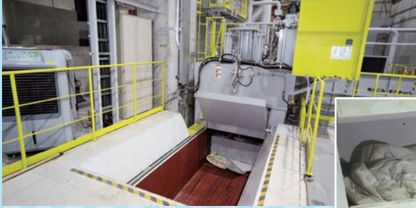
縦型切断機 畳や布団などの柔らかい燃やせる粗大ごみを、強力な刃物で一定の長さ切断します。
