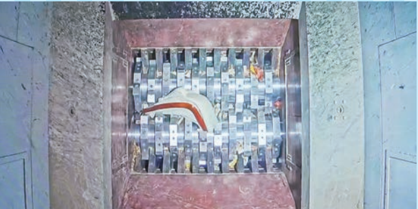
低速回転式破碎機 相互に向かい合って回転する2本の刃物で、木製家具などを細かく碎きます。
